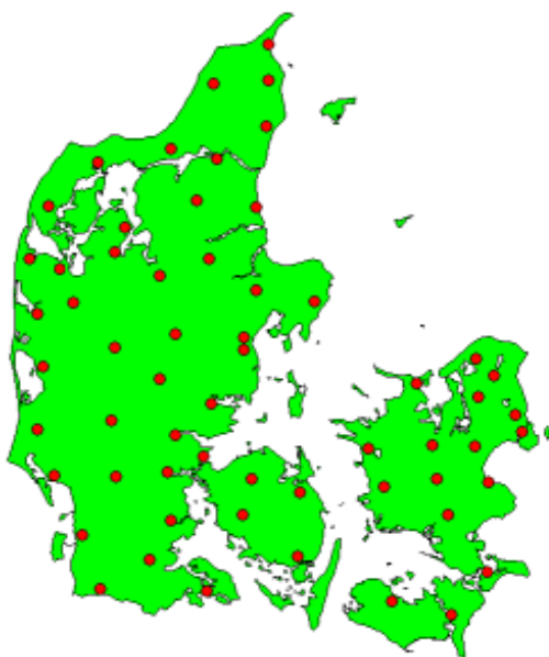
Figur 2-1 Oversigt over GPS-referencens permanente stationer i Danmark (www.referencen.dk 8/12-05).
