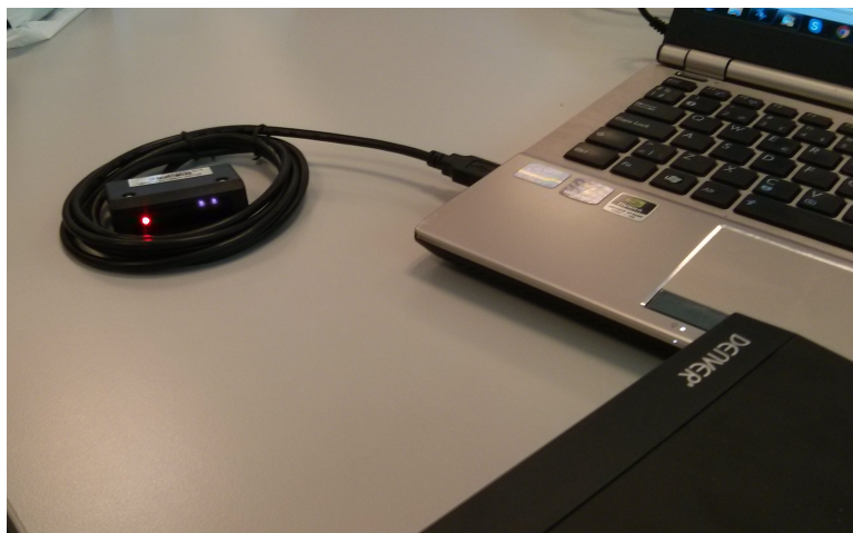
Figur 14: En USB-UJRT sender IR-signal til en DVD-afspiller. Den venstre, røde diode sender i spektret for synligt lys, mens de to lilla er infrarøde dioder, som transmitterer signalet til afspilleren
