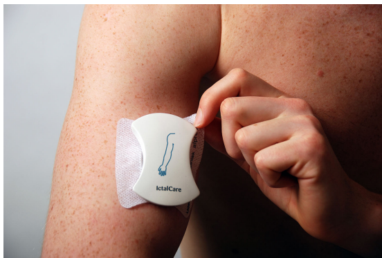
Figur 2.2: Billedet viser IctalCares plaster, hvor sensoren og batteri er indbygget. (Billede udlånt af IctalCare)
