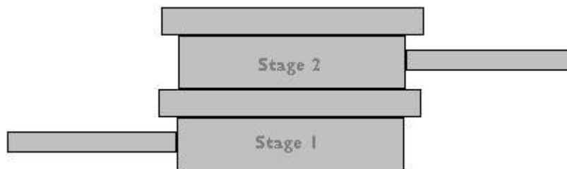
Figur 10 - Stages sammensat til en akse. Den ene af de to stages vil have en negativ kørselsretning.
