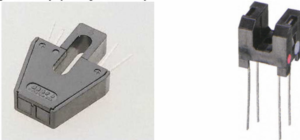
Figur 7 - Til venstre kan man se reflektoren. Til højre ses photointerrupteren, som vi har valgt at bruge til vores kalibreringer.
