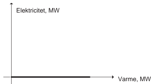
Figur 5.8: Graf over mulige produktionsmønstre for varmekedler.
