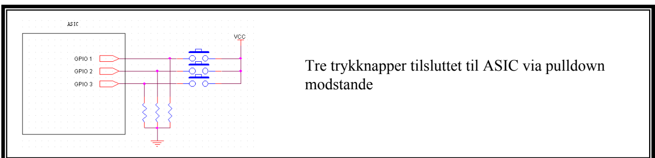
Figure 38: Tryknap tilsluttet ASIC vha. pull-down modstand
