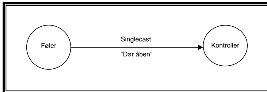
Figure 3: Singlecast pakke - En node sender en pakke til en specifik modtager
