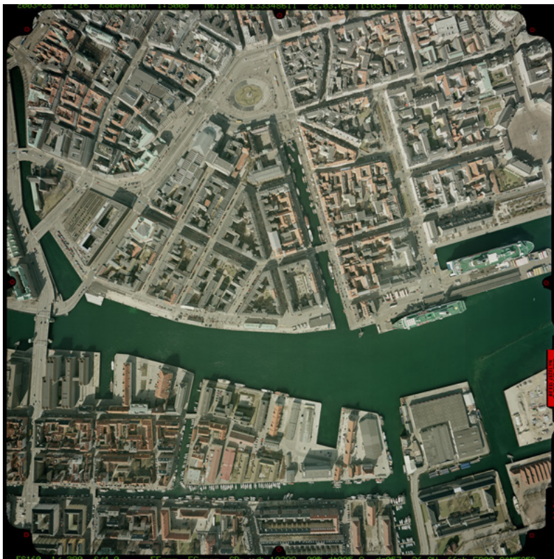
Figur 2.6: Flyfotogrammetrisk lodfoto. Negativets oprindelige format er 23cm x 23cm. Bemærk de otte rammemærker. I bunden af billedet anes annotationen, hvor forskellige nyttige oplysninger medeksponeres på filmen.
