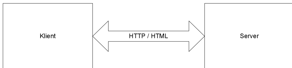
Figur 27: Webbaseret klient med minimal belastning af brugerens computer. Skærbillederne samt brugerens input bliver håndteret på serveren
