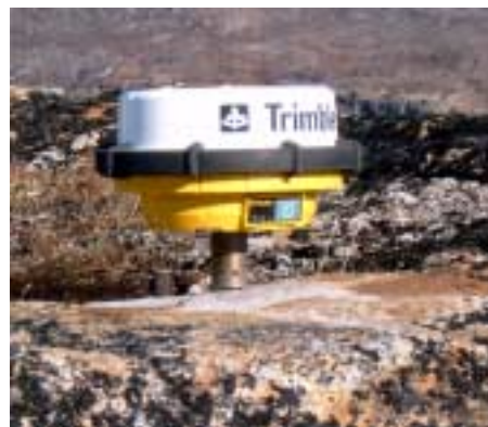
Figur 6.4: Fikspunkt defineret med en GPS-bolt
