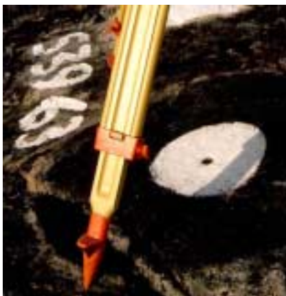
Figur 6.1: Fikspunkt markeret med et 3 cm boret hul i fjeldet.
