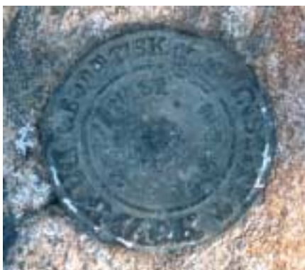
Figur 6.2: Fikspunkt markeret med GI-plade. Diameter ca. 8 cm. Læg mærke til de mange slagmærker i centrum.
