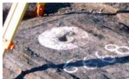
Figur 6.5: Eksempel på et dårligt defineret fikspunkt
