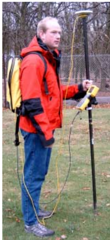
Figur 5.1: Trimble 5700 klar til brug. Antennen og TSC1 'eren sidder på en 2 m lang kulfiberstok, og modtager med batterier osv ligger i rygsækken
