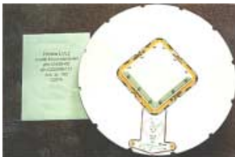
Figur 1.3: Trimble antenne med groundplane. Metalskiven skal forhindre, at signaler reflekteret fra jorden, vandet eller lignende skal nå frem til antennen. Billede fra [ http://www.ngs.noaa.gov/ANTCAL/index.shtml ] (23. januar 2003)]
