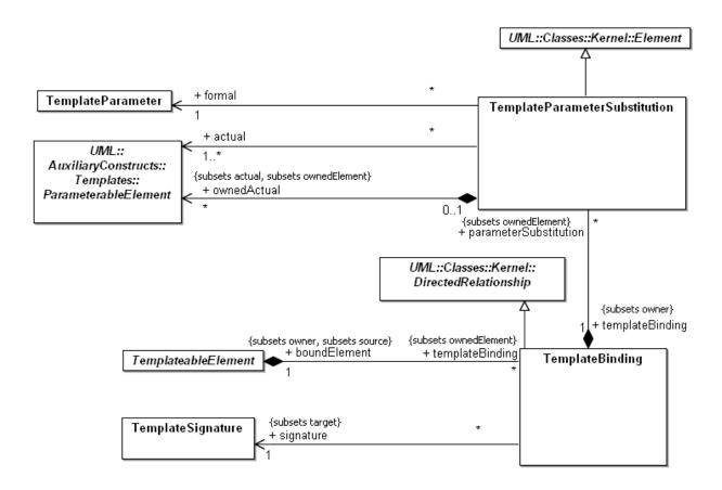
Figure 17.17 - Template parameters
